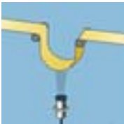
Czujnik mic+ wykorzystany do kontroli naciągu taśmy
