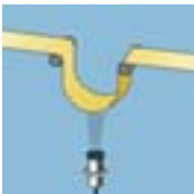
Czujnik mic+ wykorzystany do kontroli naciągu taśmy
