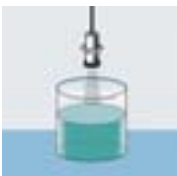
Pomiar poziomu z wykorzystaniem czujnika mic+
