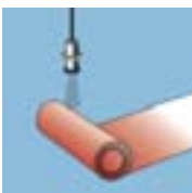
Czujnik mic+ mierzący średnicę bębna z nawijającym się na niego materiałem
