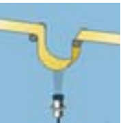
Czujnik mic+ wykorzystany do kontroli naciągu taśmy
