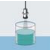
Pomiar poziomu z wykorzystaniem czujnika mic+
