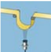
Czujnik mic+ wykorzystany do kontroli naciągu taśmy
