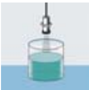
Pomiar poziomu z wykorzystaniem czujnika mic+
