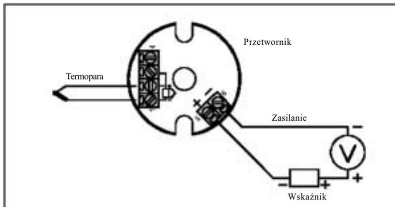
**Rysunek 6: Podłączenie termopary**
