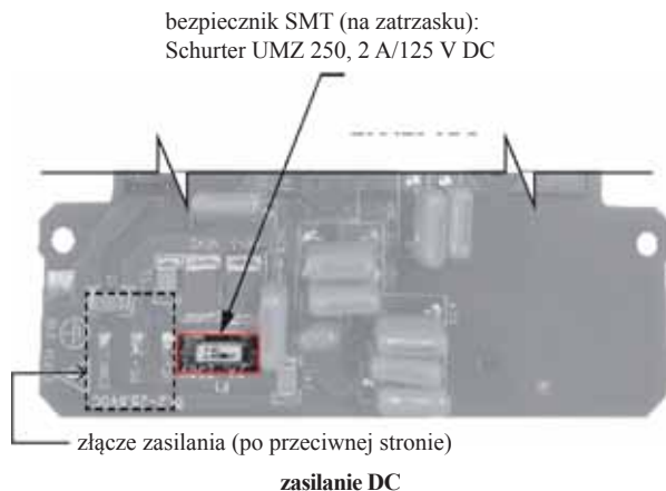
Rysunek 57 – Lokalizacja bezpiecznika, płytka zasilająca
