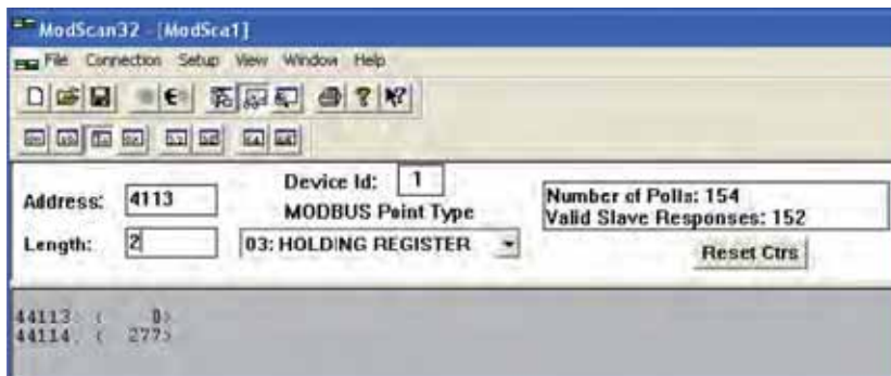
Rysunek 53 – ModScan32 podłączony do urządzenia Modbus z rejestrami 4113 i 4114 na wyświetlaczu (Rollover Count)
