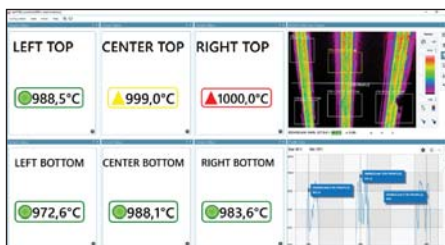
Odlewanie ciągłe z wartościami kontroli temperatury procesu i alarmami
