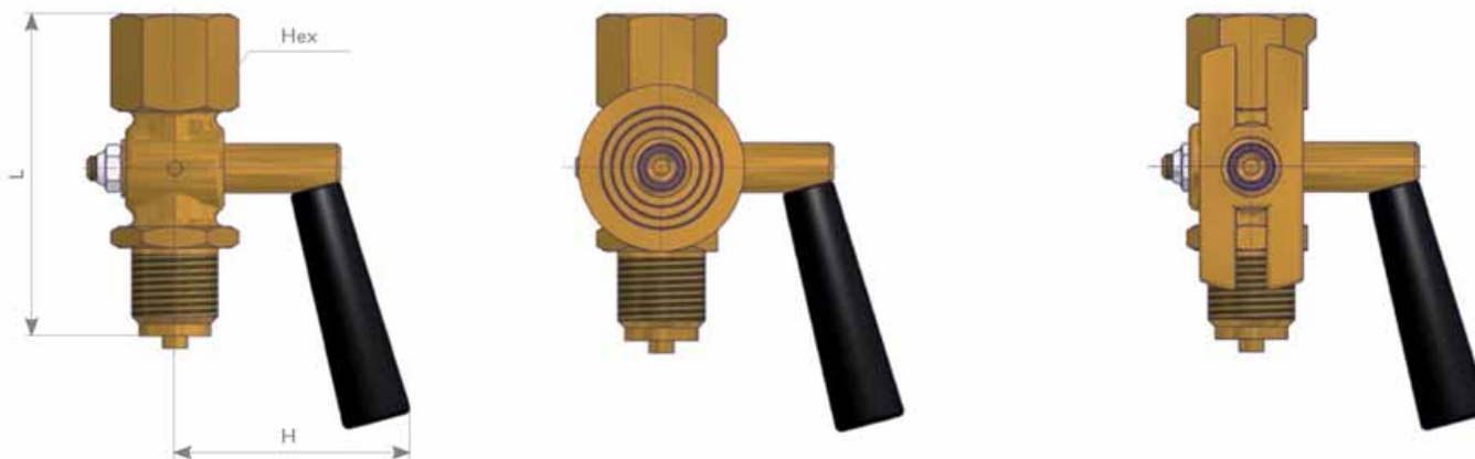
Kurek manometryczny z kołnierzem testowym \varnothing 40 \times 5
