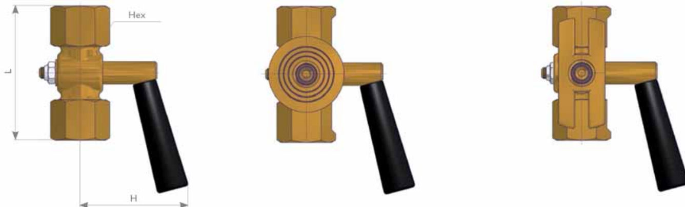
Kurek manometryczny z kołnierzem testowym \varnothing 40 \times 5
