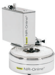
Czujnik NIR-Online z modułem X-Rot do analizy laboratoryjnej
