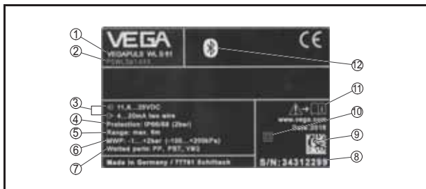
Rys. 1: Układ informacji na tabliczce znamionowej (przykład)
