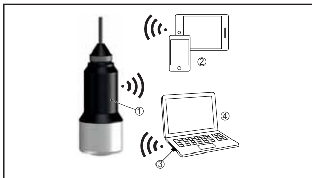
Rys. 19: Połączenie bezprzewodowe ze standardowymi urządzeniami obsługowymi.
