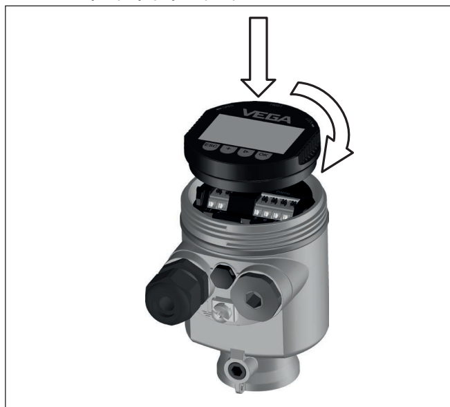
Rys. 9: Wkładanie modułu wyświetlającego i obsługowego do komory układu elektronicznego w obudowie jednokomorowej
