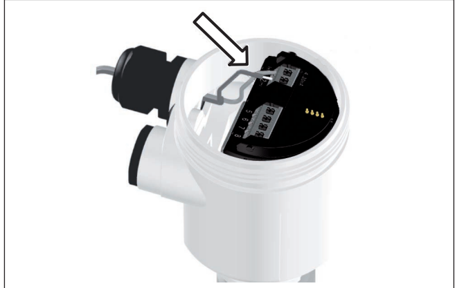
Rys. 6: Czynności przy podłączeniu 5 i 6 - obudowa jednokomorowa
