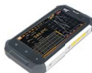
Widok tabelowy ukazujący odczyty temperatury chwilowej, minimalnej, średniej i maksymalnej, plus jedyny w swoim rodzaju tryb meltmaster (tylko w modelu 055 L).
