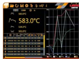
Widok tabelowy ukazujący odczyty temperatury chwilowej, minimalnej, średniej i maksymalnej, plus jedyny w swoim rodzaju tryb meltmaster (tylko w modelu 055 L).
