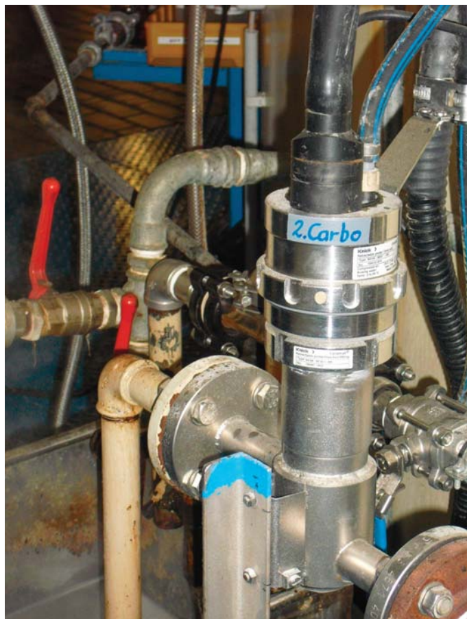
Rysunek 2: Czujnik pH zamontowany w przypadku drugiej saturacji
